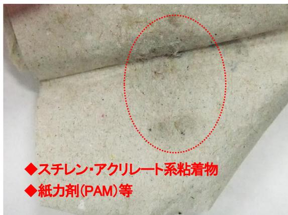
図7 抄き込み欠陥の状態
