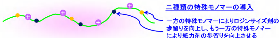
図4 新規凝結剤「リアライザーA3700」の特徴
