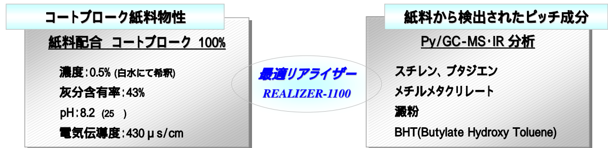
図6 試験に使用したコートブロークスラリー物性及びピッチ成分分析結果
