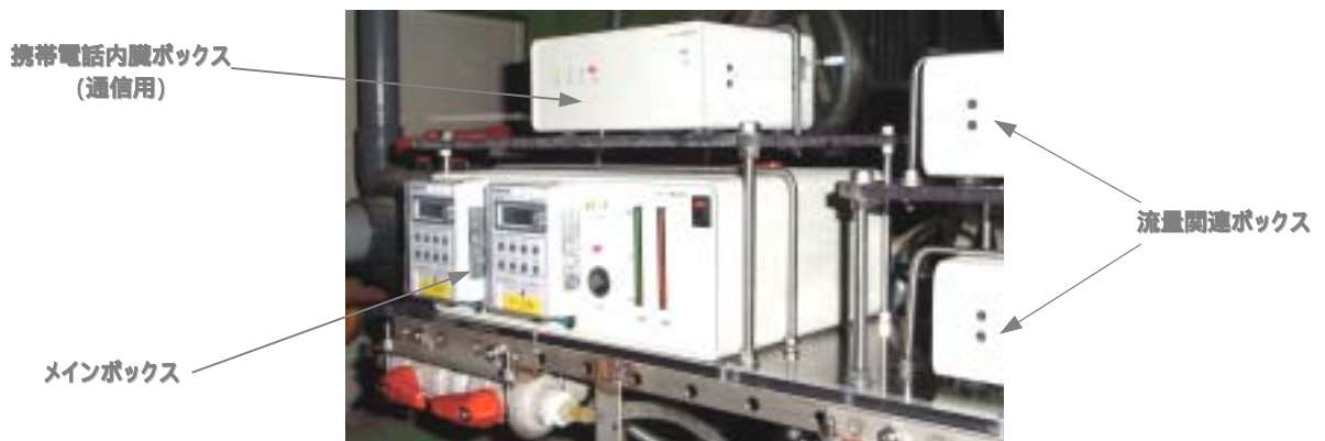
図 13 R.M.S.(リアルモニタリングシステム)製紙工場内設置状態
