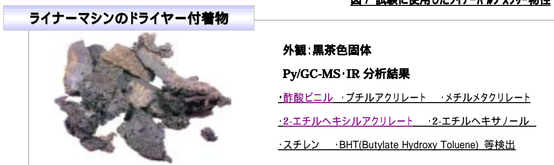
図8 ライナーマシンのドライヤー付着物写真及び成分分析結果
