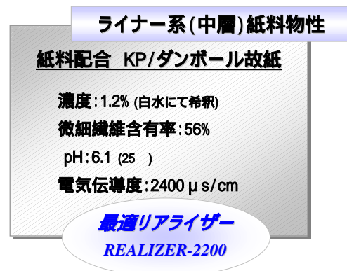
図7 試験に使用したライナーパルプスラリー物性
