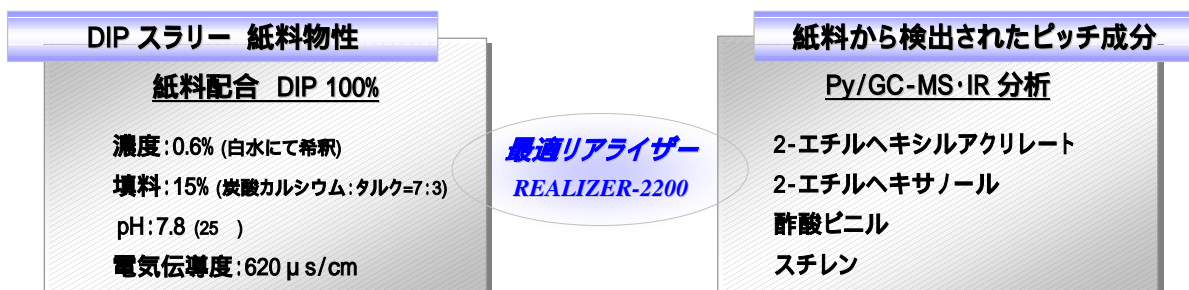
図5 試験に使用したDIPスラリー物性及びピッチ成分分析結果
